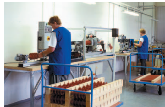
Semi-automatic special machineries for assembly of polymer arresters of modular construction. / Halbautomatische Spezialmaschinen zur Montage von Kunststoffableitern in modularer Ausführung.
